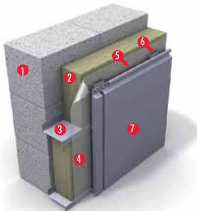
ВЕНТИЛИРУЕМЫЙ ФАСАД С ОБЛИЦОВКОЙ ИЗ МЕТАЛЛА
