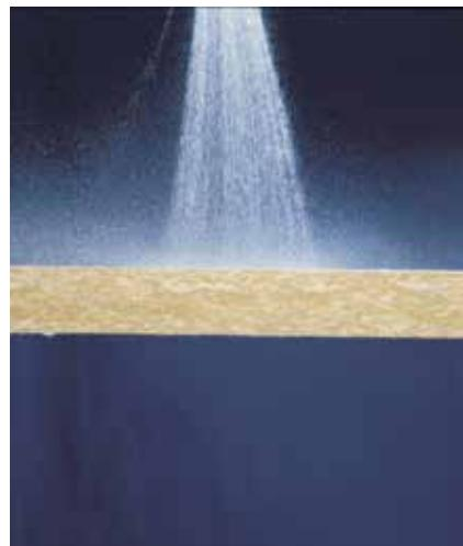
Сорбционная влажность материалов повышается при увеличении относительной влажности воздуха и снижении его температуры. Волокно каменной ваты PAROC по своей химической природе обладает водоотталкивающими свойствами (водостойкость волокна pH=1,2-1,4). Кроме того, при производстве каменной ваты PAROC применяются специальные добавки для усиления ее водоотталкивающих свойств.
