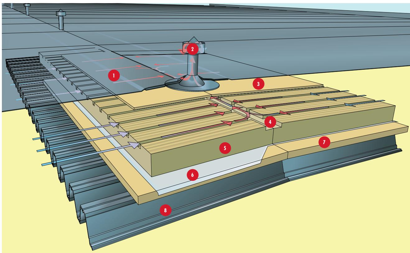
что обеспечивает движение воздуха. Данная плита служит основанием для кровельного гидроизоляционного ковра.
